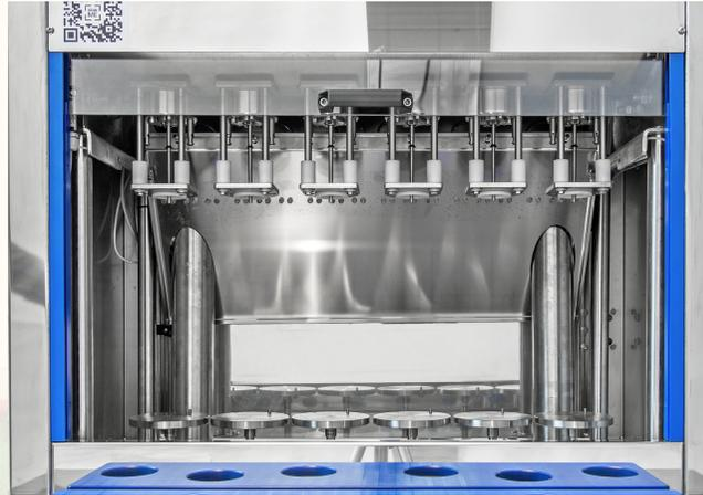
UNITÉ DE REMPLISSAGE ISOBAROMETRIQUE À 6 VANNES ÉLECTROPNEUMATIQUES
