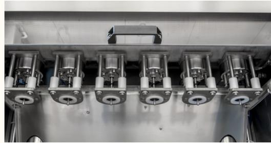
UNITÀ DI RIEMPIMENTO ISOBARICO A 6 VALVOLE ELETTROPNEUMATICHE
